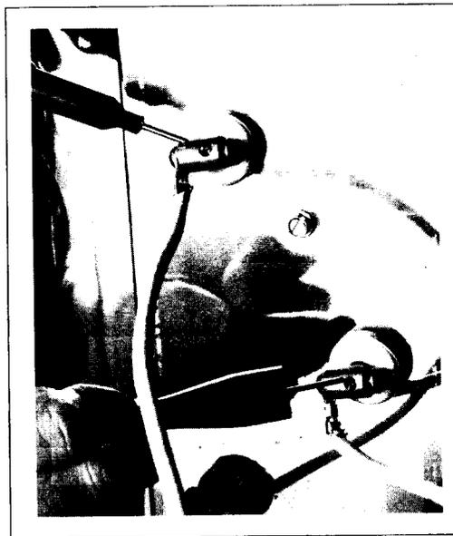
**2** Presione las puntas del medidor de ohmios contra los dos conectores de cada elemento. El no movimiento de la aguja en la escala de lectura indica que el elemento está roto (quemado).
